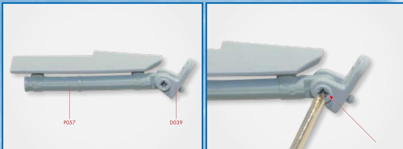
**2** Затем вставьте ухо корпуса гидроцилиндра-подъемника (P057) в проушину крепления (D039), как показано на снимке. Закрепите детали винтом НМ.
